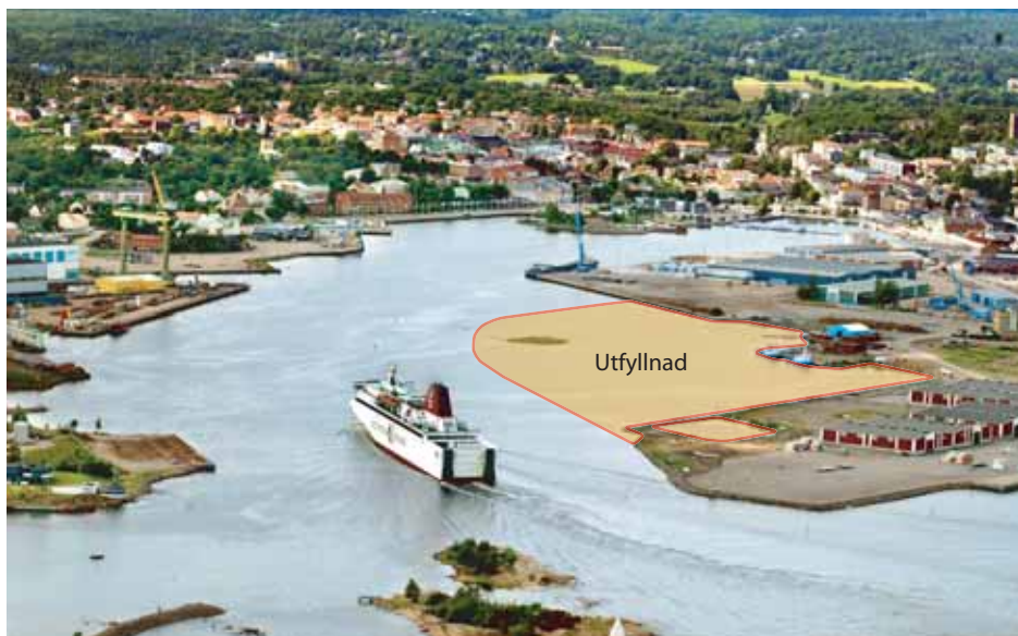
Genom en avskärmning i hamnens norra del skapas nya kajtor av de metallhaltiga men isolerade muddermassorna. FOTO: ROGER CARLSSON
