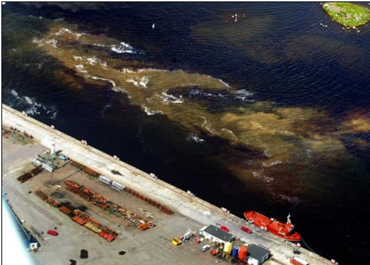
Bilden är tagen strax efter att ett fartygs propellrar rört upp sedimenten i hamnbassängen. Foto: Roger Carlsson
