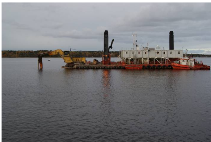
Figur 8 Exempel på mudderverk för grävuddring (t.v.) och miljöskopa (t.v.).
