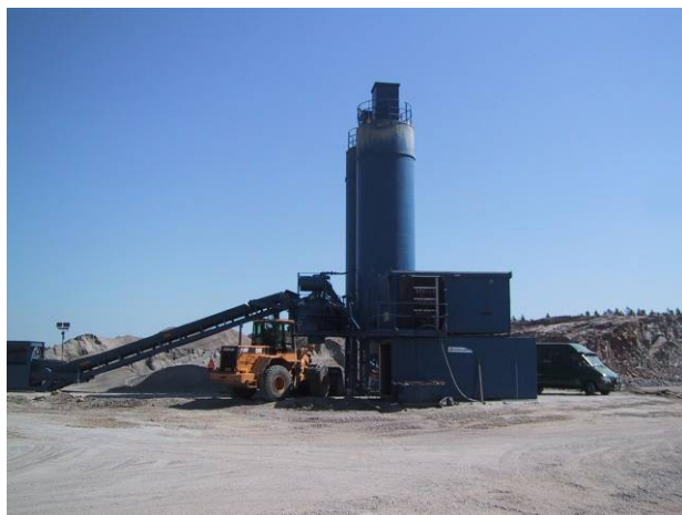
Figur 10 Exempel på en blandningsstation som kan användas för processtabilisering (t.v.) respektive inblandning av bindemedel med skruv efter utläggning (till höger).
